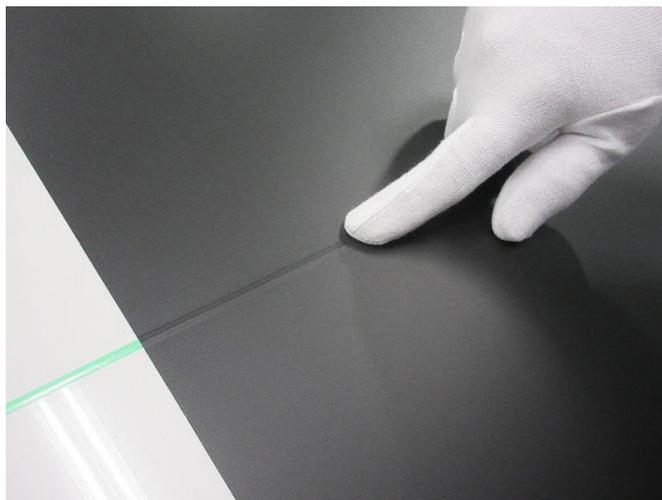
Lösen Sie an einer Seite das überstehende Ende des Knifeless Tape bis ca. 8 cm Abstand zur Folienkante ab. Falten Sie das Knifeless Tape auf sich selbst um.
