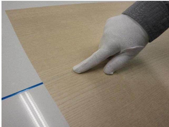
Lösen Sie an einer Seite das überstehende Ende des Knifeless Tape bis ca. 8 cm zur Folienkante ab und falten Sie es auf sich selbst um.
