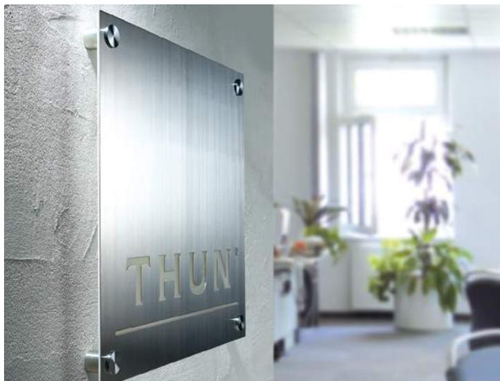
**IT** sistema di fissaggio in acciaio con chiusura laterale di sicurezza per piccoli formati. fissare il distanziale alla parete, posizionare il pannello, inserire la testina nel foro e attraverso il pannello e completare il fissaggio tramite la brugola laterale di sicurezza, che impedisce che la targa possa venir manomessa o smontata. materiale: acciaio inox AISI304, testina con sfaccettature.
